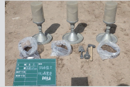
現場密度試験
